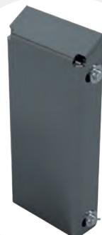
**ES.** Para absorber golpes de camiones durante la aproximación al muelle de carga. Para muelles de carga de uso intensivo. Su cubierta metálica impide el desgaste del caucho interno. Permite absorber las variaciones de altura de la caja del camión durante las maniobras de carga y descarga.
