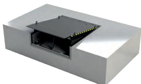
**FR.** Le Quai de Chargement Mécanique offre une alternative dans ces lieux où l'on ne dispose pas d'installation électrique appropriée. Le système de mise en marche mécanique est manuellement activé au moyen d'une chaîne liée à un dispositif articulé de ressorts qui lèvent la plate-forme et étendent la lèvre pour faciliter les tâches de chargement et déchargement.
