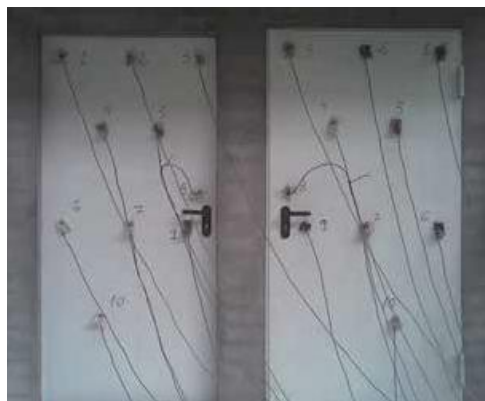
ESSAIS DE RÉSISTANCE AU FEU DES PORTES COUPE-FEU.
