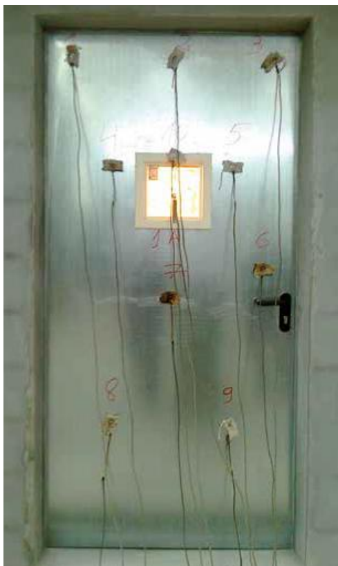
ESSAIS DE RÉSISTANCE AU FEU DES PORTES COUPE-FEU.
