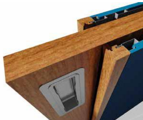
DÉTAIL LARGEUR INTÉRIEURE "UTILE" DU CAISSON.
