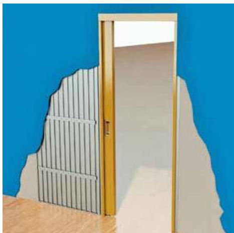
Illustration du crépissage et achèvement. Escamotage du caisson.
